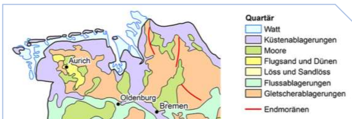
Abbildung 32 ► Geologische Übersicht über die BRNW. Die geographische Darstellung der Küstenablagerungen entspricht den Marschen, die der Flugsande und Gletscherablagerungen den Geestbereichen. (Quelle: LBEG 2017)
