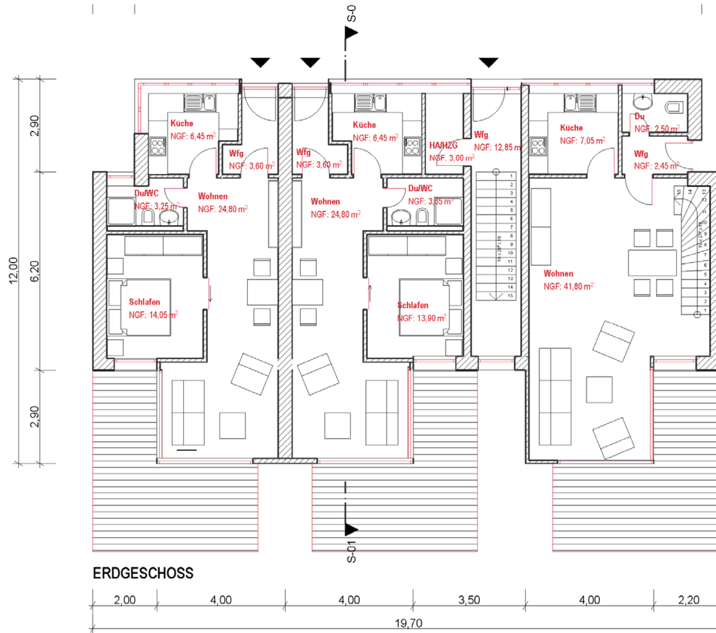
Städtebauliches Konzept Achter d' Utkiek – Erdgeschoss Gebäudetyp 1
