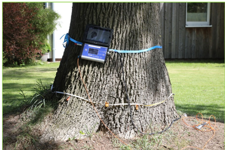
Abb. 2-1: Beispielbild, Anordnung des Schalltomographen am Stammfuß
